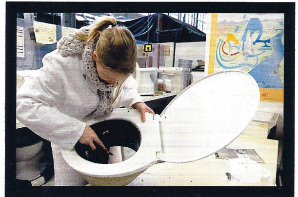
Testfall drei, der Trennklo-Bau einer Studentin: Man nehme einen Eimer, schneide eine Bodenhälfte heraus (für Festes), versehe die andere mit einem Abfluss
