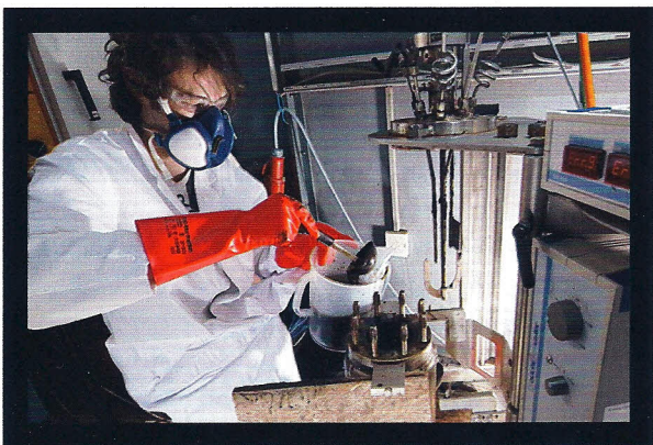
Testfall zwei: Noch fasst der HTC-Reaktor an der TU-Harburg nur drei Liter Fäkalien. Unter Hochdruck werden sie zu Kohle, geeignet als Brennstoff oder Bodenverbesserer
